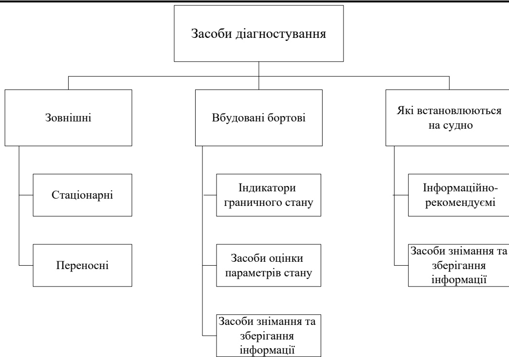
Рисунок 1 – Класифікація засобів діагностування двигуна внутрішнього згоряння
