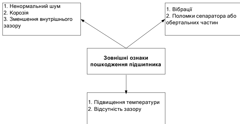
Рисунок 3 – Схема зовнішніх ознак пошкодження підшипника кочення
