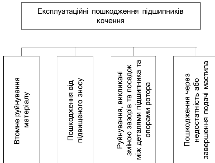
Рисунок 2 – Схема експлуатаційних пошкоджень підшипників кочення
