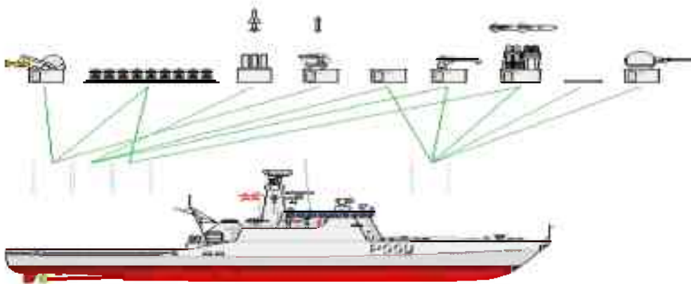
Рисунок 6 – Корабель проекту Standart Flex-300 [6, 15]: приклад встановлення модулів Stanflex у відповідності до місії корабля
