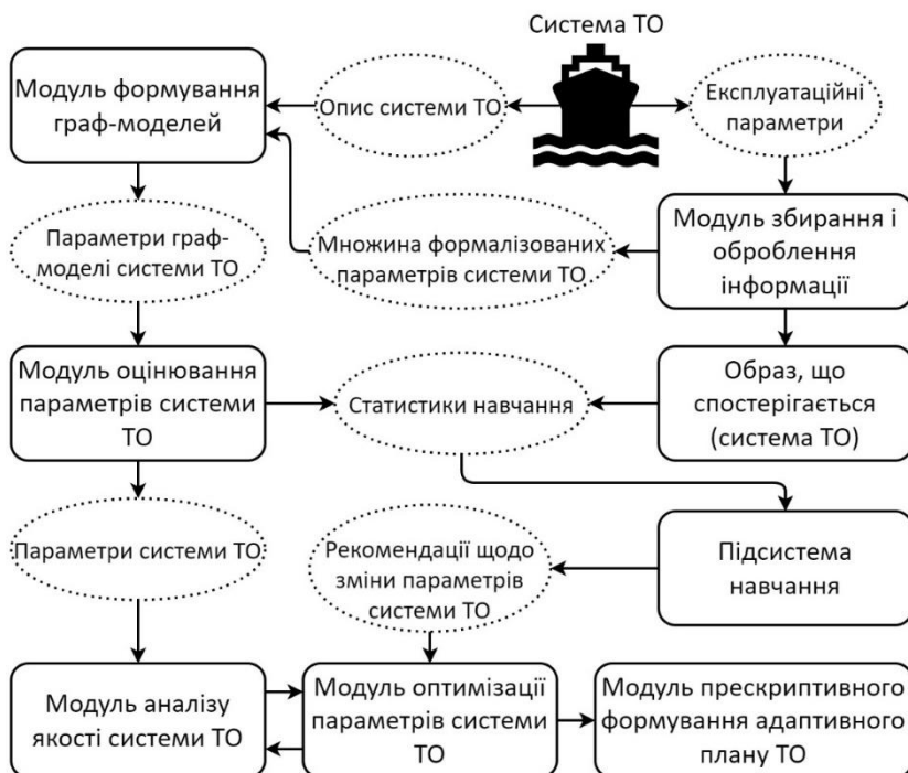
Рисунок 3 – Схема взаємозв'язків основних програмних модулів системи «Комплексного прескриптивного технічного обслуговування» вантажних суден при керуванні якістю системи технічного обслуговування вантажного судна
