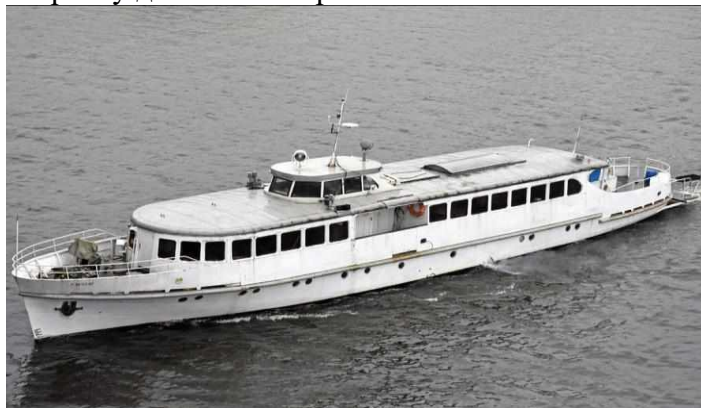
Рисунок.18. Пасажирський озерно – річковий теплохід для місцевих перевезень проєкту № 839.
