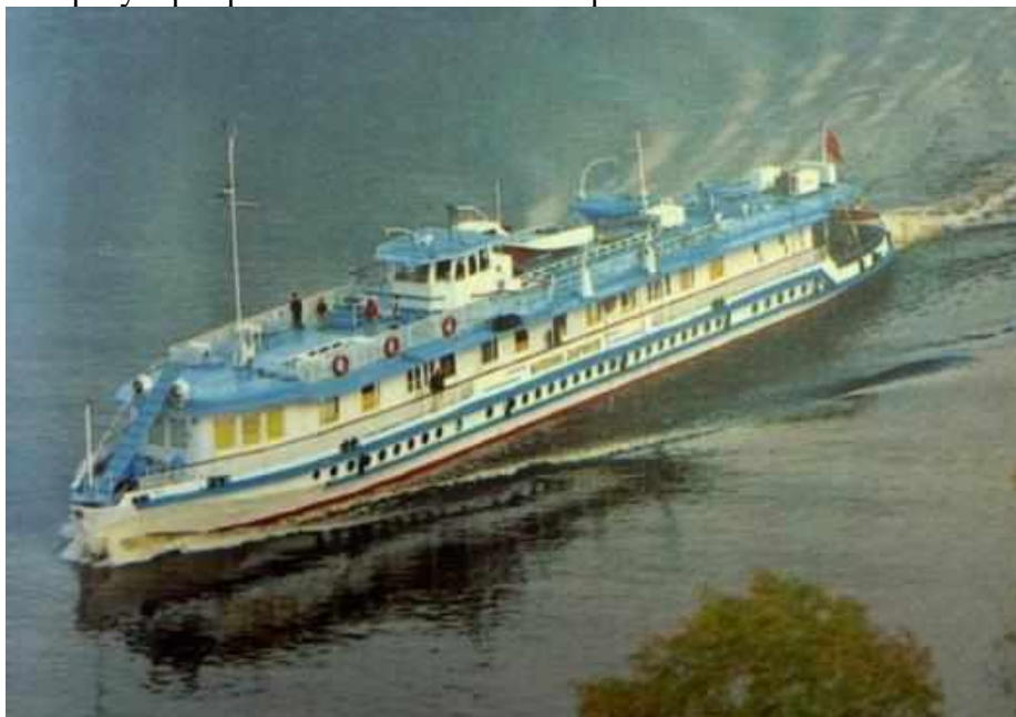
Рисунок 14. Пасажирський теплохід для малих річок проєкту № 331.
