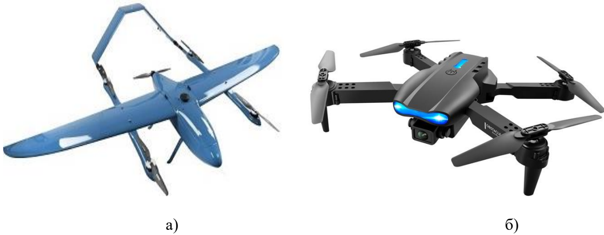
а) б) Рисунок 2 – Різні типи безпілотних літальних апаратів: а) літакового типу з нерухомим крилом; б) багатороторний
