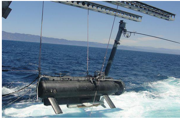
Рисунок 6 – Встановлення роботизованого інспекційного інструменту з допомогою ДКПА За матеріалами [32]
