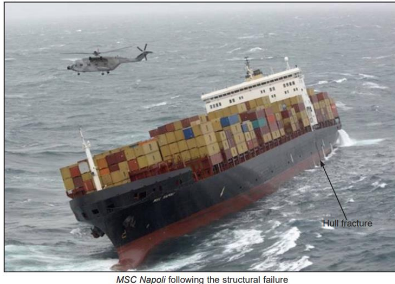
Рисунок 1 – MSC Napoli з розламаним корпусом
