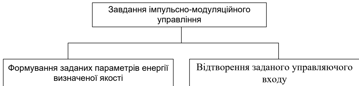
Рисунок 2 – Завдання імпульсно-модуляційного управління електроенергетичними судновими установками
