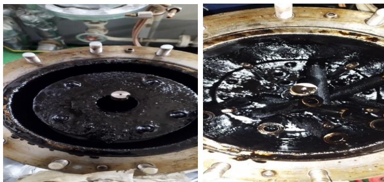
Рисунок 4 – Автоматичний фільтр після 2 годин роботи при високому рівні алюмосилікатів в паливі (Джерело: фотографії з суднового архіву).
