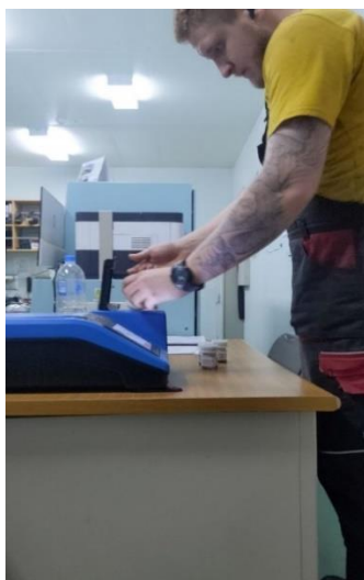
Рисунок 2 – Процес аналізу зразків палива за допомогою приладу MobilServ CCM Kit
