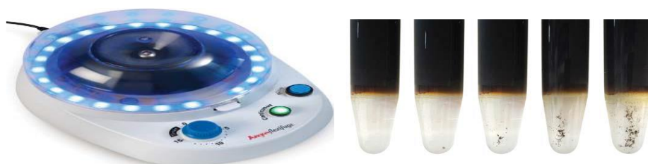
Рисунок 1 – Центрифуга та мікроцентрифужні пробірки з різним вмістом алюмосилікатів з тест-набору Cat Fines Check [36]
