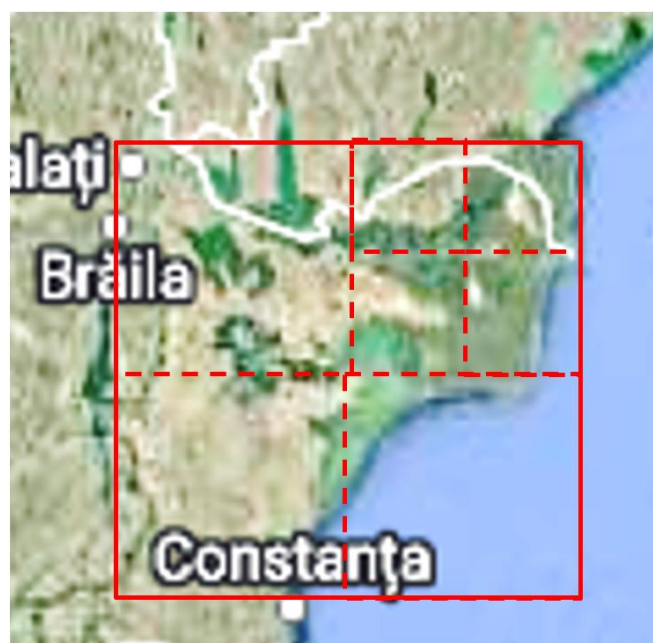
Рисунок 3 - Схема [18] блокової подільності регіону Придунав'я з просторовими масштабами 140x140; 70x70; 35x35 км.
