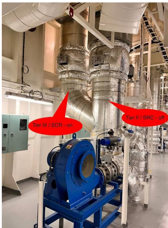
Рисунок 2 – Розташування обладнання, що забезпечує очищення випускних газів, в машинному відділенні судна
