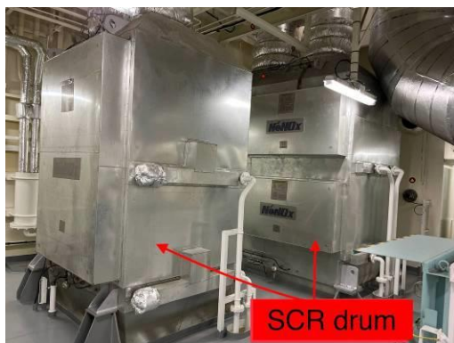
Рисунок 2 – Розташування обладнання, що забезпечує очищення випускних газів, в машинному відділенні судна
