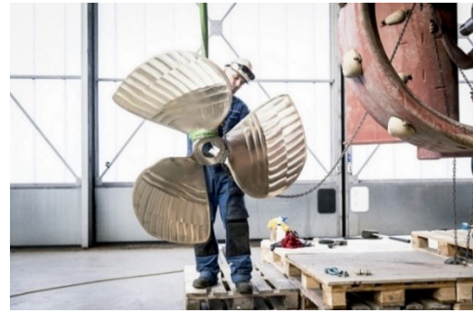
Рисунок 5 – Перший в світі гребний гвинт, що зроблений на 3-D принтері (джерело: [25])
