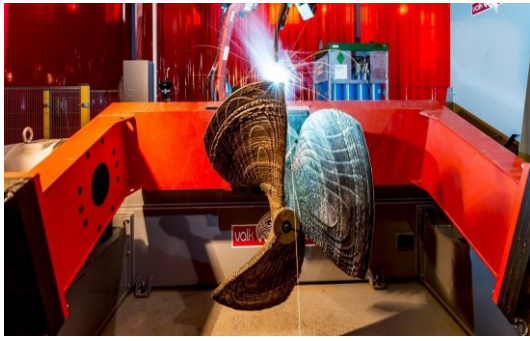
Рисунок 5 – Перший в світі гребний гвинт, що зроблений на 3-D принтері (джерело: [25])
