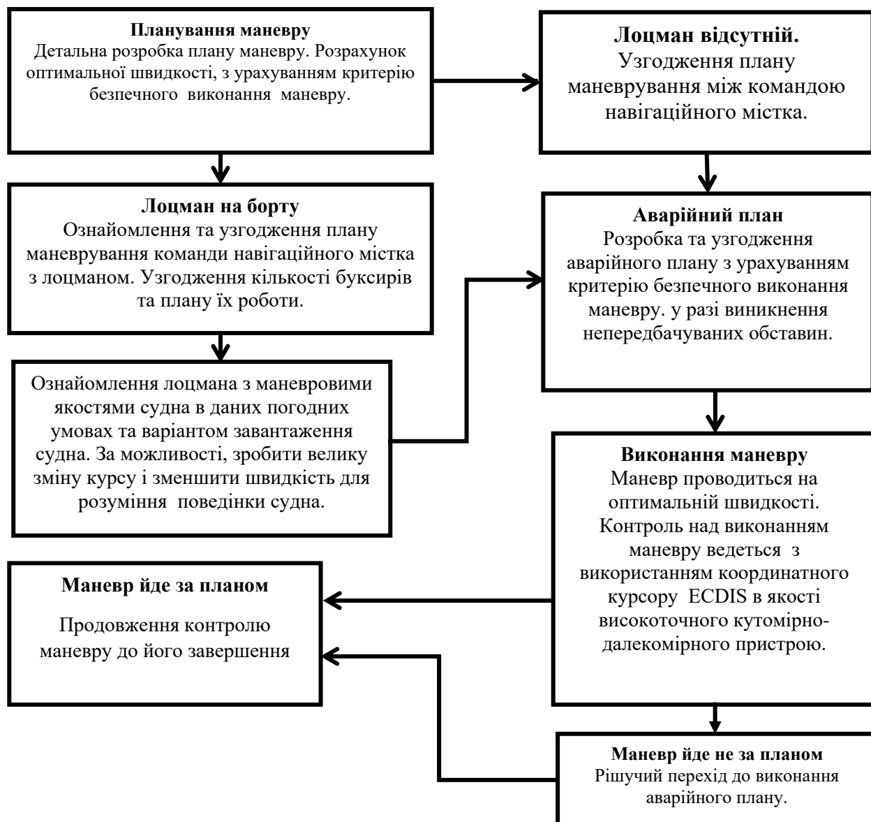
Рисунок .2 – Узагальнений алгоритм роботи суднового містка суден контейнеровозів при експлуатації в складних навігаційних та гідрометеорологічних умовах.
