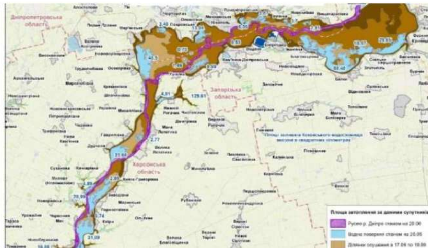
Рисунок 14 - Карта-схема поточних змін руслових процесів на Дніпрі, пов’язаних з руйнуванням греблі Каховської ГЕС [21].
