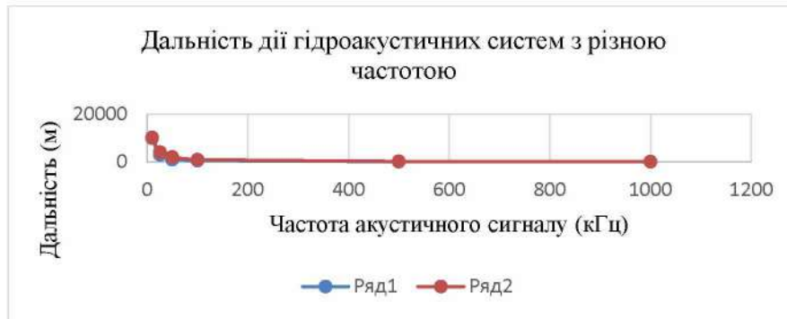
Рисунок 1 – Дальність дії гідроакустичних систем (розрахована – червона; експериментальна – синя) залежно від довжини хвилі (наведено діапазон 10 - 1000 кГц).
