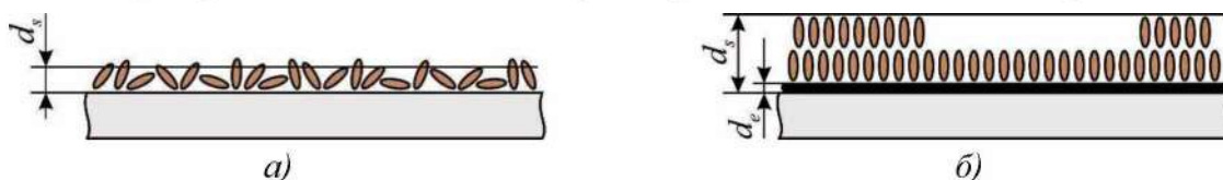
Рисунок 4 – Зміна товщини граничного шару мастила для різного стану металевій поверхні: а – без нанесення на поверхню шару епіламу; б – з нанесенням на поверхню шару епіламу; d_s – товщина граничного шару мастила; d_e – товщина адсорбованого шару епіламу
