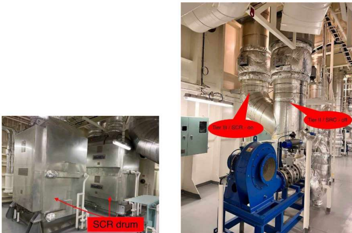
Рисунок 2 – Розташування обладнання, що забезпечує очищення випускних газів, в машинному відділенні судна
