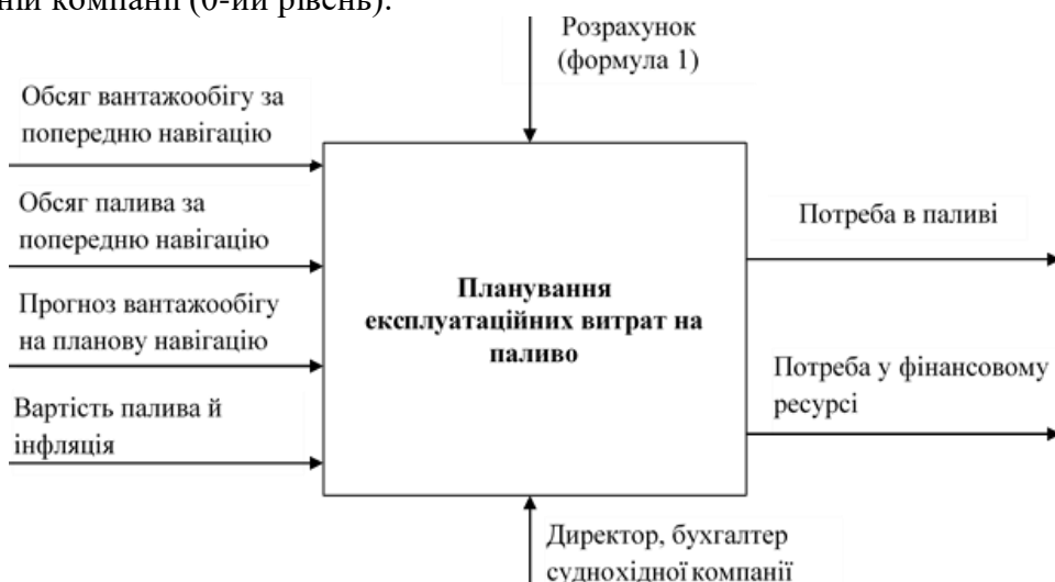
Рисунок 3 – Модель планування експлуатаційних витрат на паливо (“As is”)
