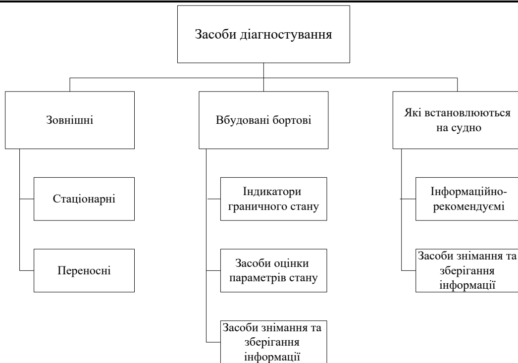
Рисунок 1 – Класифікація засобів діагностування двигуна внутрішнього згоряння
