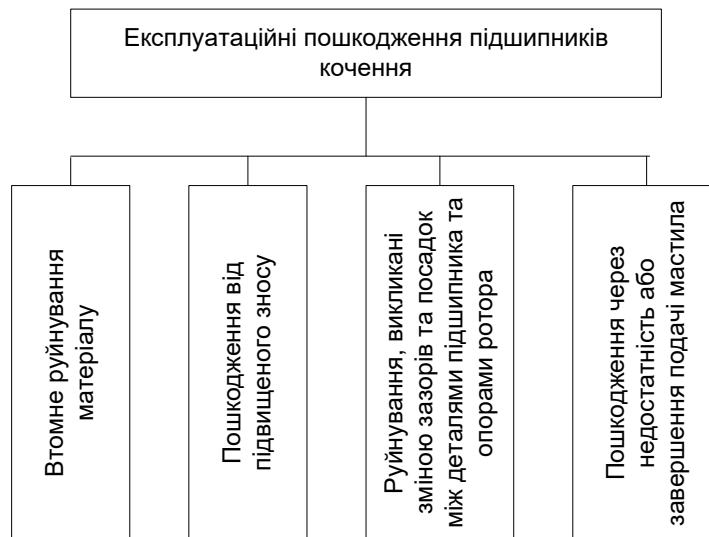
Рисунок 2 – Схема експлуатаційних пошкоджень підшипників кочення
